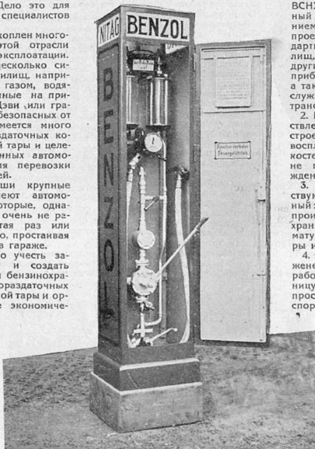
Немецкая бензино-раздаточная колонка с ручным насосом и автоматическим счетчиком
