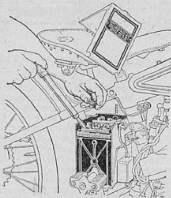
Рис. 6. Доливка жидкости в банку аккумулятора при помощи пипетки
